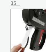
Presione el gatillo de la etiquetadora en el momento que va a retirar el remanente de liner atascado para así lograr un total despeje del mismo | Press the labeler trigger while the liner residue is removed in order to achieve a total clearance of the label | Pressione o gatilho na rotuladora no momento de retirada do liner atulado até total remoção.
