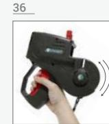
Si persisten restos de liner dentro de la etiquetadora, sacuda la etiquetadora (presionando y soltando el gatillo) hasta que los restos caigan | If remnants persists inside the labeler, shake it (pressing and releasing the trigger) until the remnants falls | Se os detritos persistirem, agite a marcadora (pressionando e soltando o gatilho) até que os detritos caíam.
