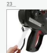
Retire el remanente de liner deslizándolo en dirección opuesta a la etiquetadora | Remove the liner remnant by sliding it in the opposite direction of the labeler | Remova o remanescente deslizando-o na direção oposta da etiquetadora.
