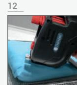
Apoye la etiqueta expuesta sobre la carga a etiquetar | Put down the label on the labeling load | Apoie a etiqueta exposta na carga a ser rotulada.
