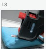
Deslice la etiquetadora hasta que toda la etiqueta quede pegada en la carga | Slide the labeler back until you see the entire label stuck on the surface of the load | Deslize a rotuladora de forma a que a etiqueta seja afixada na carga.
