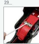
Con ayuda de un hisopo y disolvente, limpíe la superficie y rodamientos en los que se observe resto de adhesivo | Rub a swab with solvent onto surfaces and bearings where adhesive remnants are observed | Com a ajuda de um cotonete e solvente, limpe a superfície e os rolamentos onde se observem restos de adesivo.
