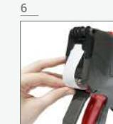
Inserte el extremo del liner en la ranura presionando el gatillo | Insert the end of the roll into the slot by pressing the trigger | Insira a extremidade do liner na ranura puxando o gatilho.
