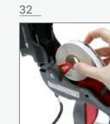
Saque el rollo de etiquetas de entre los sujetadores desplazando el rollo hacia arriba | Remove the roll from the fasteners by moving the roll upward | Remova o rolo de etiqueta dos fixadores movendo o rolo para cima.
