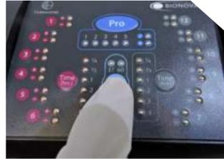
Presionar el botón Temp. durante 3" para ingresar al modo de selección de temperatura. Presionar nuevamente para seleccionar la temperatura deseada.
